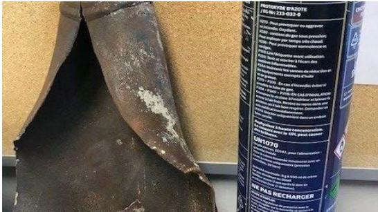
A gauche, une bonbonne de protoxyde d'azote explosée
